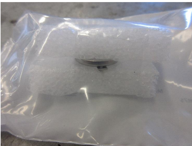
Abbildung 10: Verpackung für beschädigte Batterien kleiner 500g
