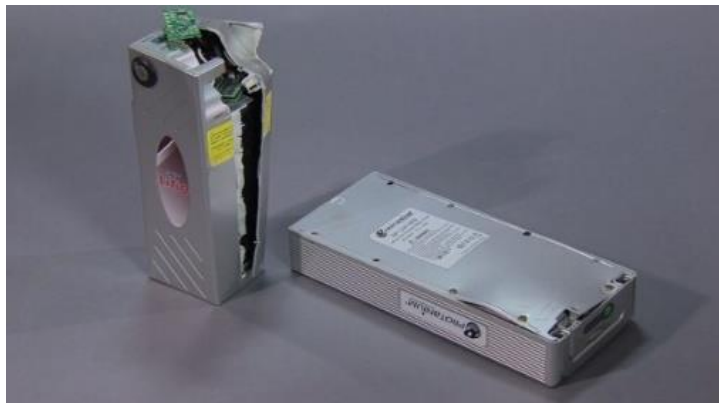
Abbildung 12: Beispiele für defekte Batterien mit Gefährdungspotential (aufgeplatzte Hülle, schnelle Zerlegung und Entzündung möglich)
