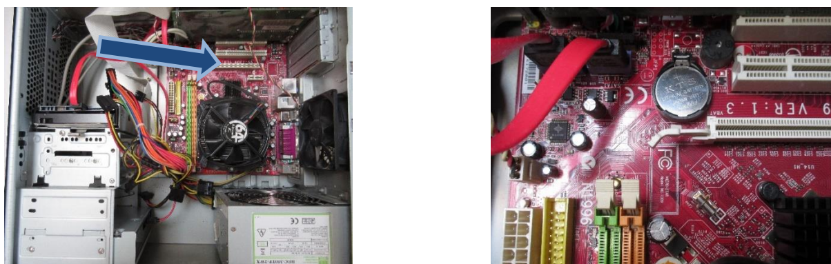
Abbildung 14: Stützbatterie Typ CR 2032, 3 Volt auf PC-Platine
