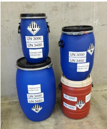
Abbildung 8: Verpackung für Batterien größer 500g unbeschädigt
