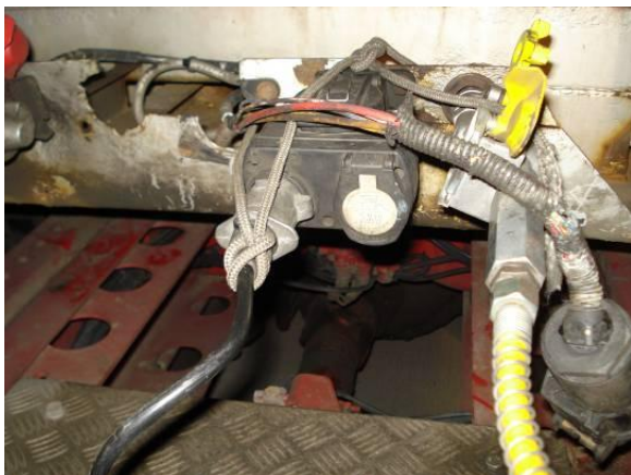
Bild 05 und 06 Auch diese Steckverbindung ist seit längerer Zeit unbrauchbar und musste dem Fahrer im Rahmen der Abfahrkontrolle aufgefallen sein. Dennoch wurde das Fahrzeug in Betrieb genommen.
