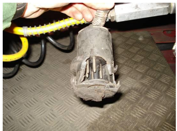
Bild 05 und 06 Auch diese Steckverbindung ist seit längerer Zeit unbrauchbar und musste dem Fahrer im Rahmen der Abfahrkontrolle aufgefallen sein. Dennoch wurde das Fahrzeug in Betrieb genommen.
