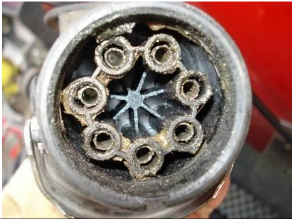
Bild 01 und 02 7-polige Steckverbindung für die Spannungsversorgung des EBS vom Anhänger. Die Steckdose (links) ist völlig verrottet und war seit langer Zeit nicht mehr in Gebrauch.
