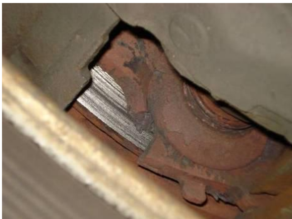
Bild 03 und 04 Das sind die materiellen Folgen an einem EBS gebremsten Anhänger, wenn die ISO 7638 Verbindung dauerhaft nicht hergestellt wurde. Alle Radbremsen des nur drei Jahre alten Fahrzeugs sind durch die permanenten Vollastbremsungen völlig verschlissen, die Bremsklötzer teilweise gebrochen.
