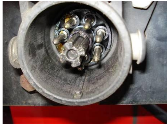
Bild 01 und 02 7-polige Steckverbindung für die Spannungsversorgung des EBS vom Anhänger. Die Steckdose (links) ist völlig verrottet und war seit langer Zeit nicht mehr in Gebrauch.
