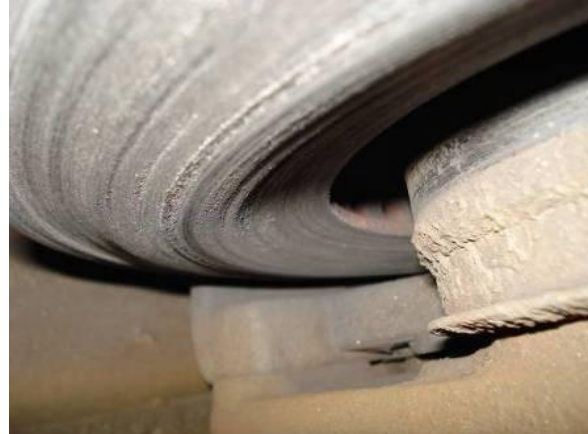
Bild 03 und 04 Das sind die materiellen Folgen an einem EBS gebremsten Anhänger, wenn die ISO 7638 Verbindung dauerhaft nicht hergestellt wurde. Alle Radbremsen des nur drei Jahre alten Fahrzeugs sind durch die permanenten Vollastbremsungen völlig verschlissen, die Bremsklötzer teilweise gebrochen.
