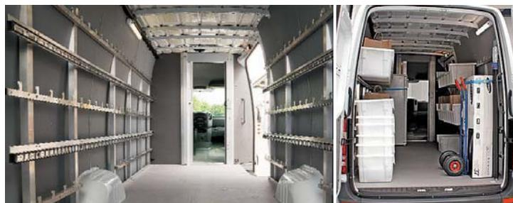
Das **TRAGUFIX** System macht aus jedem Transporter ein Raumwunder für den sicheren Warentransport. Mit dem **TRAGUFIX** Profilsystem kann auch großvolumiges Transportgut einfach und schnell an den integrierten Zurrschienen fixiert werden
